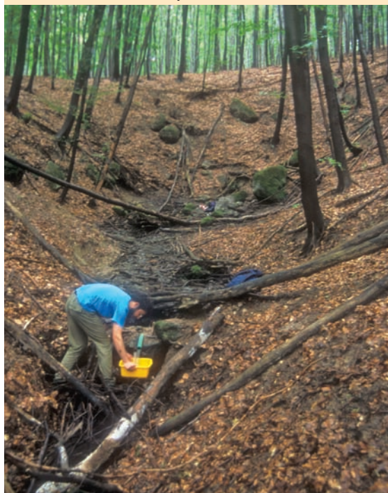
A forráskataszterezés fontos mozzanata a vízhozam-mérés hitelesített mérőedénnyel (K. G.)
